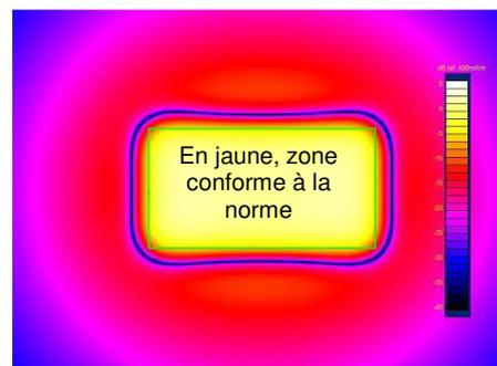
Il y a d'autres restrictions à l'utilisation des boucles simples périmétriques. Le champ magnétique d'une boucle se propage librement dans l'air et au travers de tous les matériaux isolants quels qu'ils soient. En revanche LE METAL - visible ou non - situé dans l'environnement (ferraillages de béton, planchers techniques, ossatures de faux plafond ou de cloisons, fermes, circuits aérauliques, etc.) affecte le fonctionnement des boucles et entraîne plusieurs conséquences :
