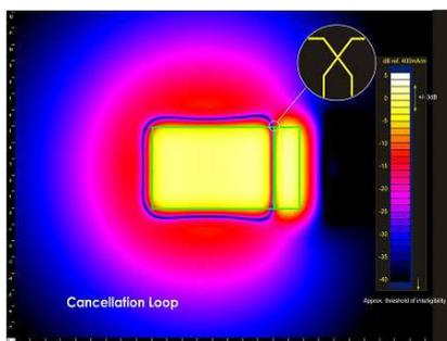
**Réaliser un système de boucle d'induction magnétique ne consiste donc pas à disposer systématiquement un fil autour d'une pièce ou d'une zone délimitée, au sol ou au plafond.**
